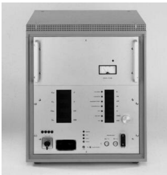
Рис. 3. Внешний вид устройства для определения R_{thjc} компании Lorlin Test Systems.
