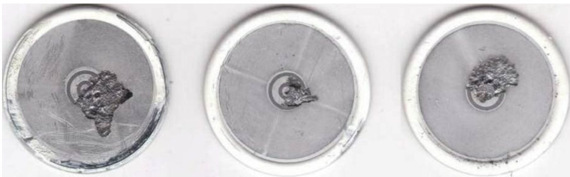
Рис. 3. Фотографии отказавших СТ типа Т143–630 с характерными проплавлениями ПС в области УЭ.
