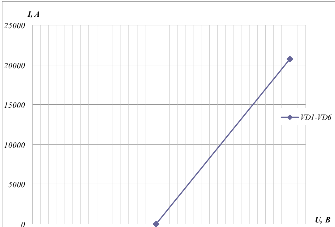
Рис. 5. ВАХ VDI-VD6 с одинаковыми величинами параметров U_{F0} , r_F .
