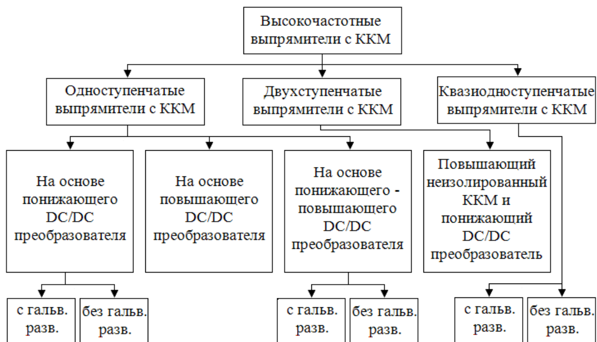
Рис. 1. Классификация высокочастотных выпрямителей с ККМ
