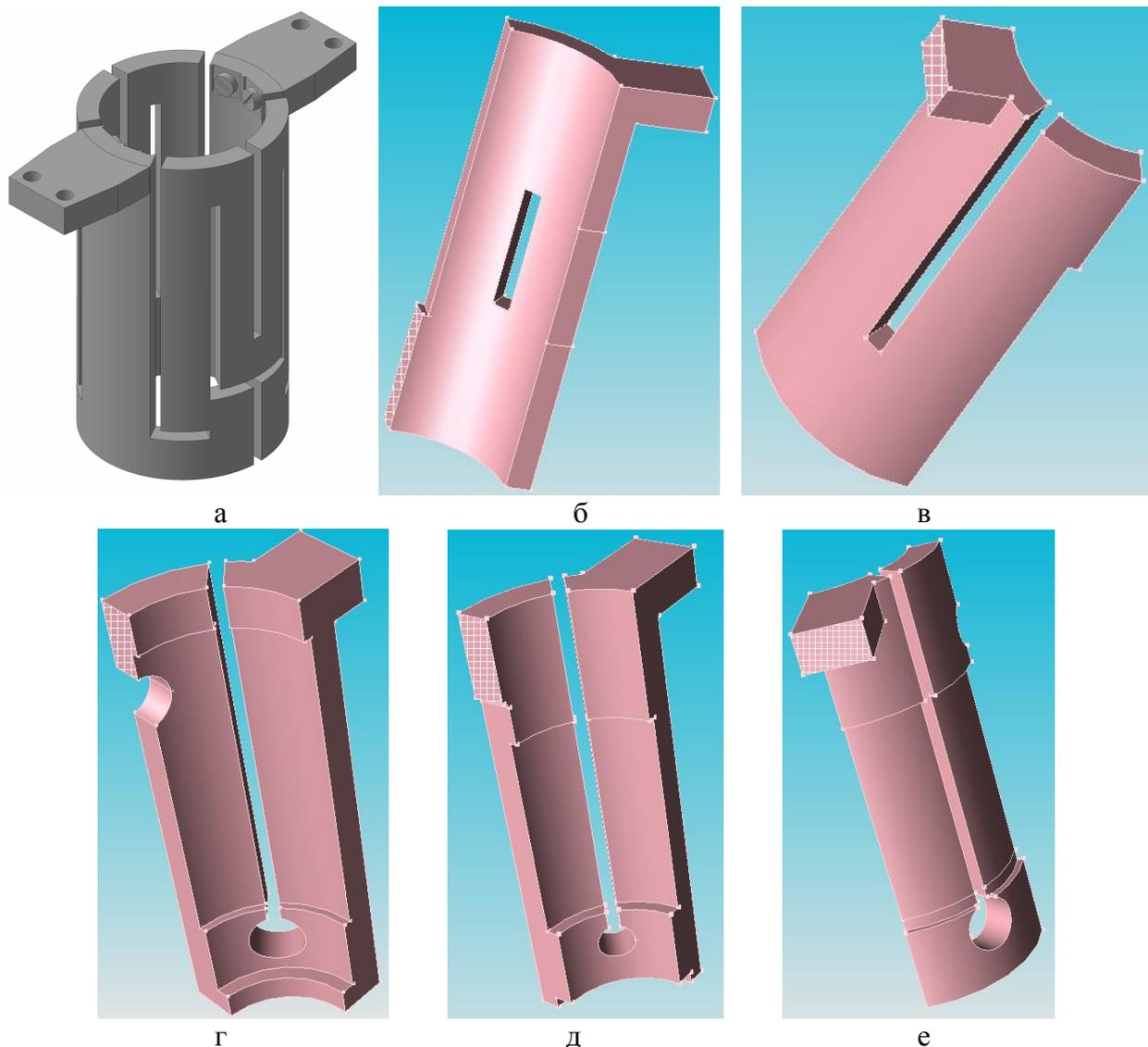
Рис.1. Основные варианты конструкции нагревателя.
