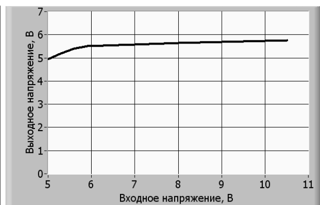
Рис. 8. Зависимость выходного напряжения стабилизатора от величины входного напряжения.
