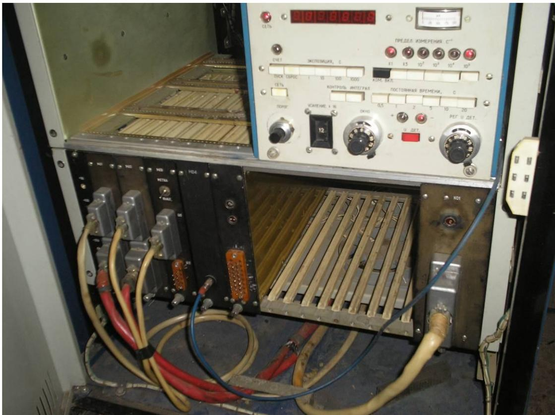
Рисунок 1 – Блоки стандартной системы управления дифрактометра ДРОН-УМ1.
