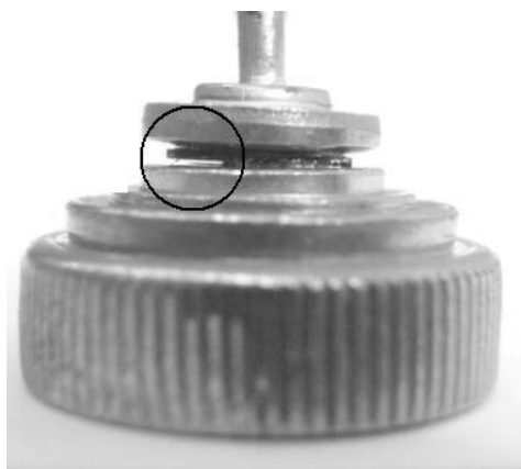
Рис. 7. Диод КД2969 с дефектом спая ПС и корпуса прибора.
