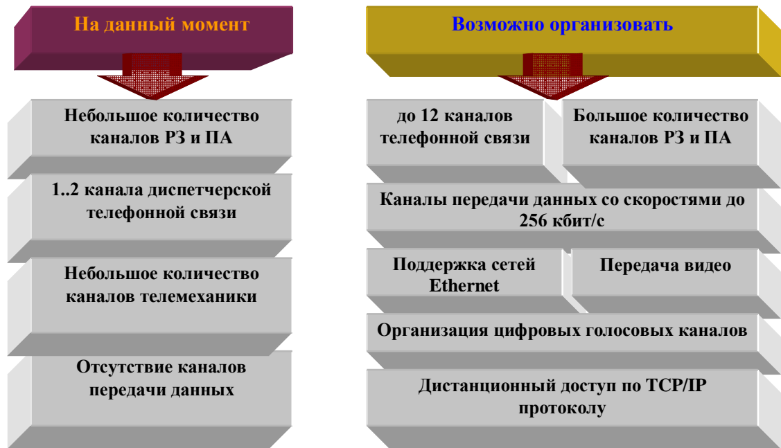
Рис. 4 схема сравнения каналов связи существующих и после модернизации.
