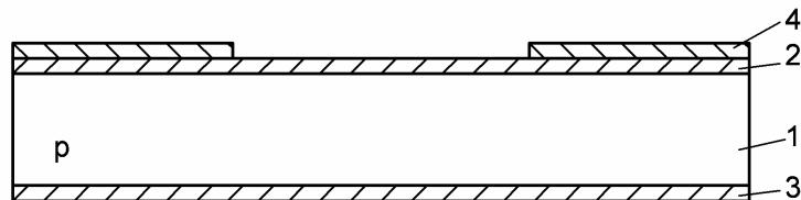
б – пластина с фоторезистивной маской на рабочей стороне
