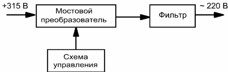
Рис. 3. Структурная схема инвертора +315\text{ В} \rightarrow \sim 220\text{ В}
