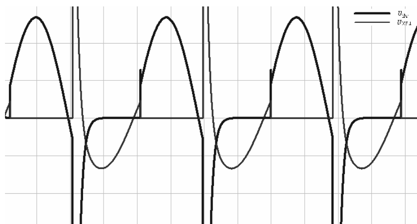
Рис. 9 – Форма напряжения на тиристоре ( U_{VS1} ) и электродвигателе ( U_{dv} ) при одинаковых параметрах снабрных RC -цепей и параметрах самих приборов в конце процесса пуска электродвигателя
