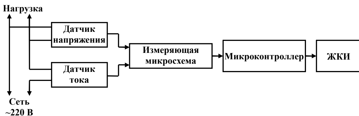
Рис.1. Структурная схема однофазного измерителя коэффициента мощности
